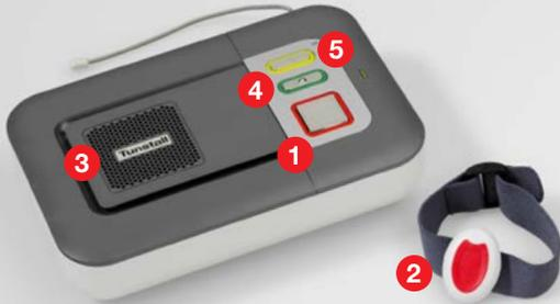
Ein Druck auf die **Notfalltaste 1** oder den **Funksender 2** baut eine direkte Verbindung zur rund um die Uhr besetzten Hausnotrufzentrale auf. Das Gespräch erfolgt über eine integrierte **Freisprecheinrichtung 3**.
